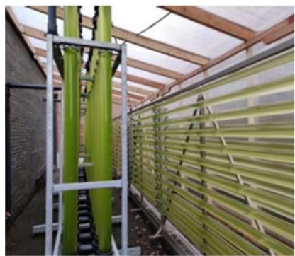
Slika 22 Unutarnje pilot postrojenje za proizvodnju mikro-algi
