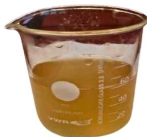
Slika 15 Amonijev nitrat dobiven iz tekuće frakcije digestata
