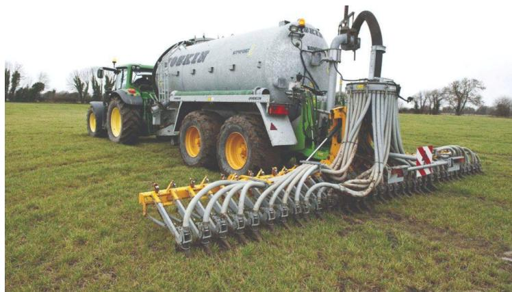
Slika 12. Strojni linijski sustav u kombinaciji s injektorom ([link](#))
