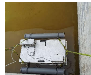
Imatge mostreig emissions Bassa final d'aigua.
