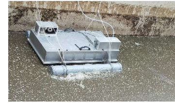
Imatge mostreig emissions Bassa final.
