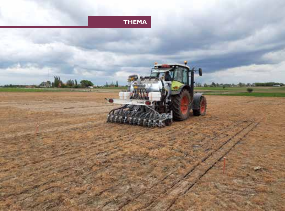
Acht verschillende meststoffen werden met deze proefveldbemester toegediend aan verschillende dosissen en in verschillende herhalingen. Zo werden er 100 verschillende proefveldjes aangelegd op een perceel van 2 ha.
