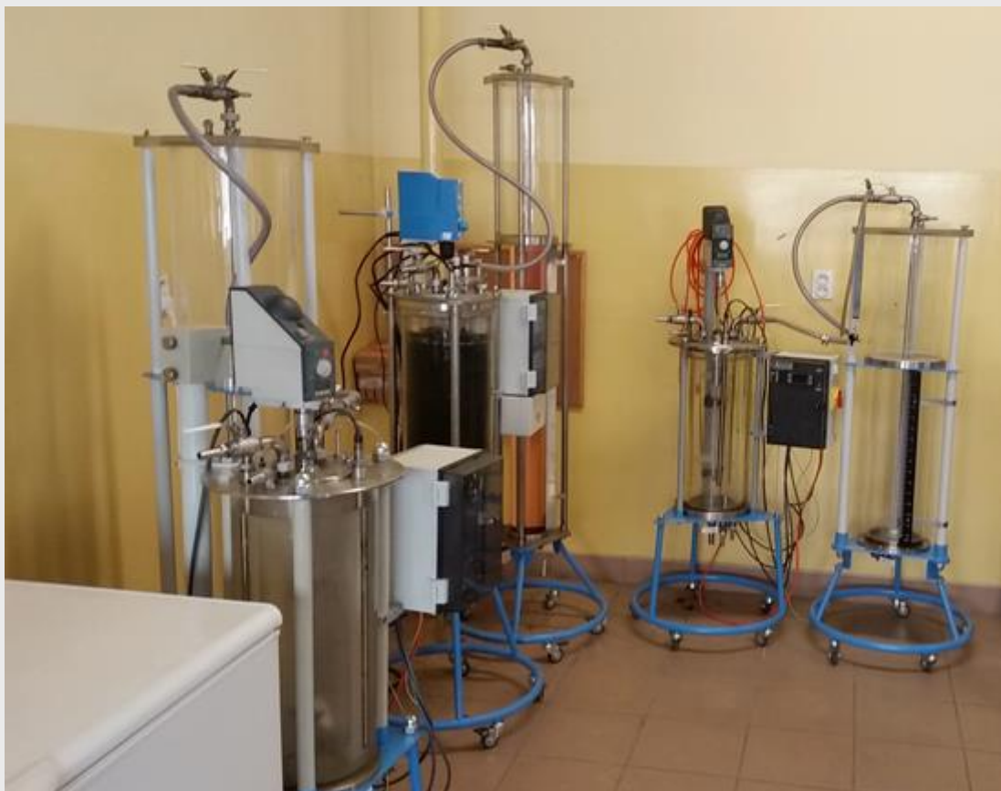
Rysunek 2. Komory fermentacyjne w których realizowane są badania w ramach projektu Nutri2Cycle
